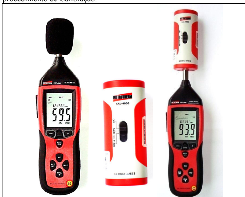
Figura 22- Equipamentos utilizados nas medições do Nível de Pressão Sonora(NPS): a) Medidor de Nível Sonoro DEC-490 (INSTRUTHERM); b) Calibrador Acústico Cal-4000 (INSTRUTHERM); c) Medidor de Nível Sonoro em procedimento de Calibração.
